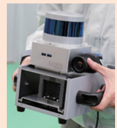
廃炉現場の汚染分布を3次元マップで「見える化」する「iRIS」
